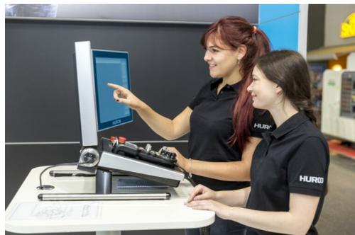
Die 5-Achs-Maschinen der SRTi-Reihe sind mit der Dialogsteuerung „WinMax“ – wahlweise mit DXF-Option – ausgestattet. Die leistungsstarke Software der Steuerung von HURCO vereinfacht die Programmierung bei 5-Seiten-Bearbeitungen und schafft in nur drei Schritten die
